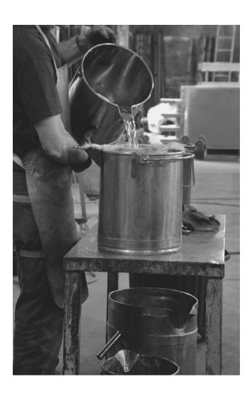
La polymérisation d'une plaque Dacryl se fait par un principe physique de liaison moléculaire. Cette liaison est activée par un échauffement à basse température du monomère.
