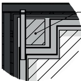
systeme de pivot démontable pour installation et réglage porte en partie haute
