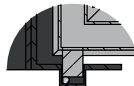
Pivot à insérer dans perçage au sol avec billes acier de glissement
